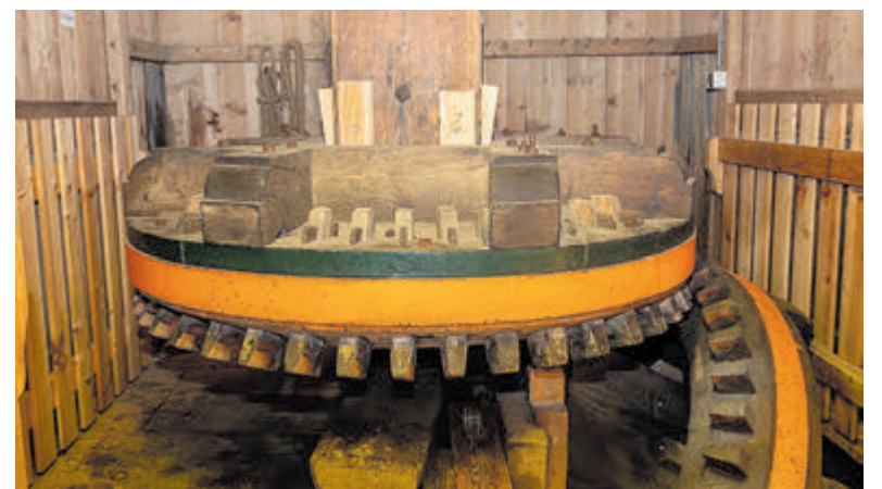
Het hart van de molen: de onderbonkelaar (horizontale deel) is gekoppeld aan het vijzelwiel (rechts). De middelste as is de Koningsspijl en loopt naar boven. Foto: Henk de Reus
