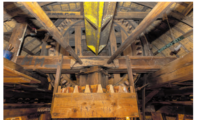
Kijkje op de bovenste verdieping: aan de gele as zijn de wiken van de molen (buiten) gekoppeld. Om de as bevindt zich het bovenwiel dat gekoppeld is aan het horizontale wiel (bovenbonkelaar). Deze laatste is verbonden met de Koningsspijl die naar beneden voert. Foto: Henk de Reus
